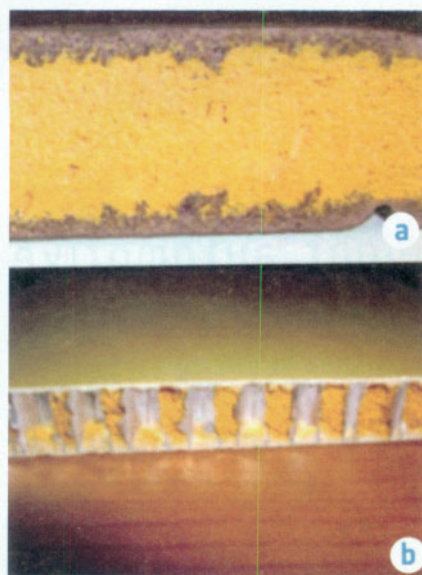
图2 (a) SMC在泡沫中的渗透截面 (b) 蜂窝结构在模压阶段与板形成一个整体
